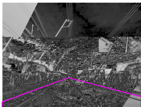
図 4 射影変換による位置合わせ後の差分画像（輝度差の絶対値）
