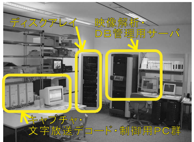
図 3: 画像自動獲得・蓄積システムの全景
