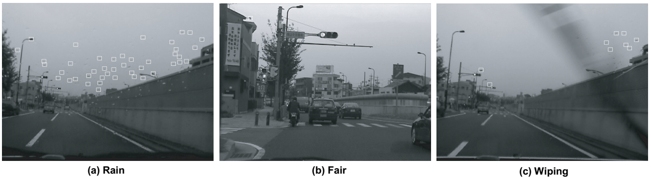
図 9 手法 2 をデータ 2 に適用した雨滴検出結果の一例 ( S(a) \geq 0.78 )
