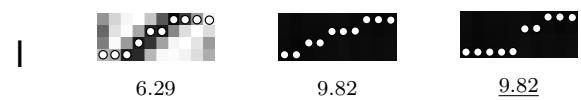
図 11 撮影者 A の文字 l に対して作成された類似度の DP 平面．各手法によって求めたマッチングパスは，DP 平面中に円で示す．数字は類似度を示す．下線は，そのカテゴリの類似度之和が全カテゴリ中で最大となることを表す．
