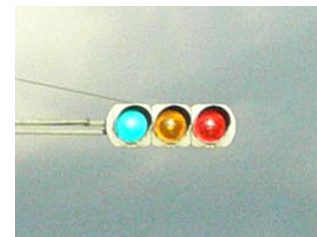
図 3 太陽光による擬似点灯 . 太陽光が入射することで , 非点灯中の信号機の輝度が上昇することで , 何色が点灯中か見分けにくくなる .
