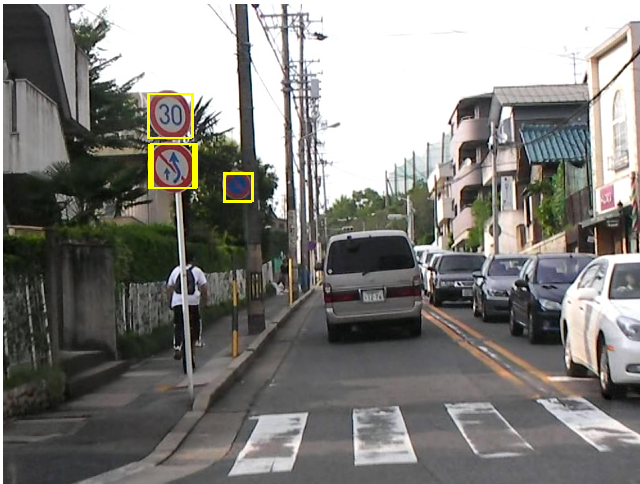
図 9 傾いた標識の検出例
